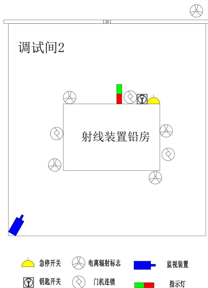
图 10-2 工业 X 射线检测装置安全措施示意图
