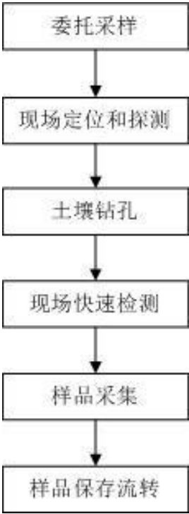
图7.2-1 土壤样品采样流程图
