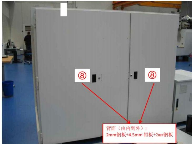
图 10-2 项目屏蔽结构示意图
