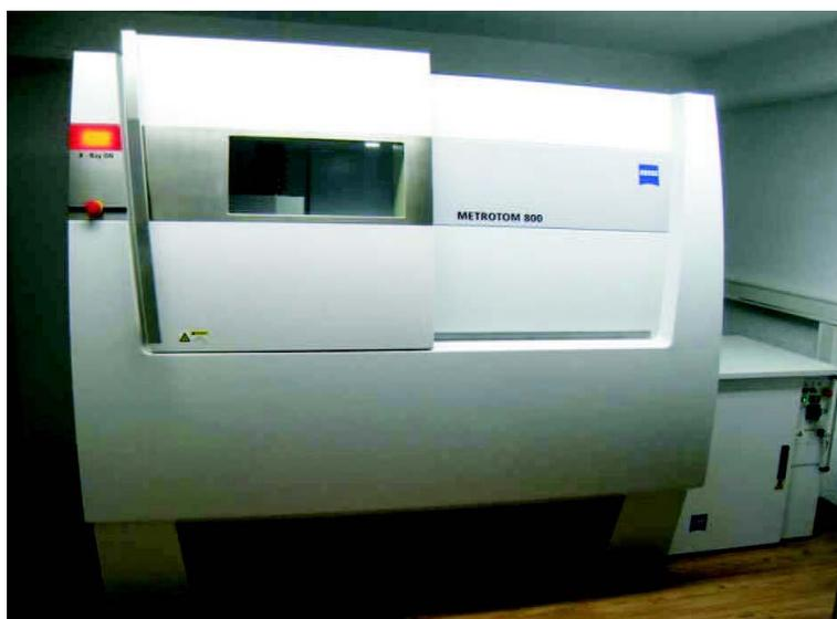
**图 9-1 METROTOM 800 130kV 型工业用 X 射线计算机断层扫描（CT）外观图**
